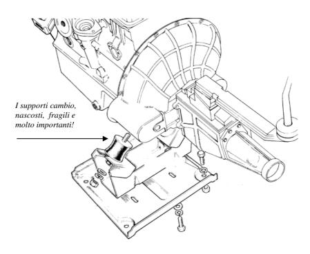
ritornerà nella posizione originale e le vibrazioni e rumori diminuiranno sensibilmente. La sostituzione è semplice, con l'ausilio di un buon cric idraulico e di un paio di cavalletti richiede solo qualche ora di lavoro
