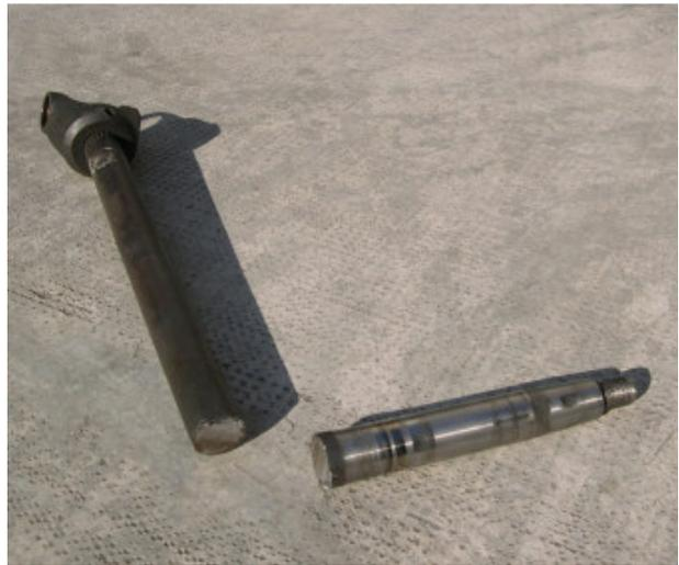
*La rottura improvvisa del semiassie provoca il distacco parziale della ruota posteriore con conseguenze molto gravi. Per fortuna l'anomalia si è manifestata su strada rettilinea a due corsie di marcia senza traffico e la sbandata è stata corretta abbastanza facilmente. E' sicuramente un caso anomalo e raro ma vi consigliamo di controllare lo stato dei semiassi periodicamente, sia nelle crociere che nelle flange del differenziale e nella zona vicino al mozzo.*
