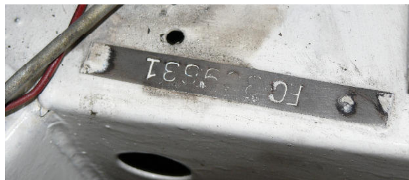
Questa targhetta applicata sul telaio nella parte sinistra non è da considerare in quanto riporta una numerazione utilizzata durante la produzione per l'abbinamento con la scocca e la rintracciabilità durante l'assemblaggio sulla linea di montaggio.
