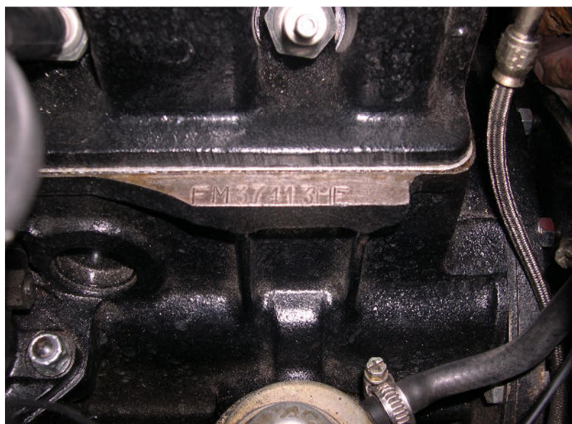
Il numero del motore veniva punzonato sullo scalino del basamento vicino alla 4° candela. Controllare sempre che la sigla motore corrisponda a quella riportata sul libretto di circolazione
