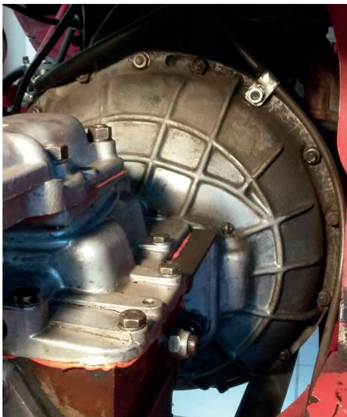
1) il cambio e la campana della frizione prima dello smontaggio
