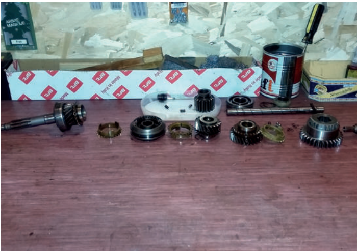
4) gli ingranaggi del cambio ed i sincronizzatori (in ottone) smontati
