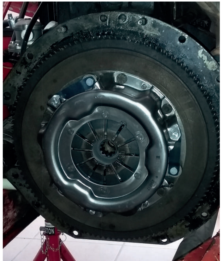
7) la nuova frizione con relativo spingidisco montati sul volano motore
