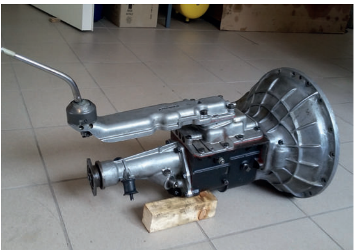
5) il cambio riassembleto pronto per il rimontaggio
