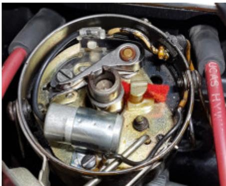
Ogni cosa delle nostre auto è stata progettata dagli ingegneri per permettere la regolare funzionalità di specifici componenti della vettura. Come avrete visto dalla foto stiamo parlando dello SPINTEROGENO, componente essenziale per il funzionamento del motore che tuttavia
