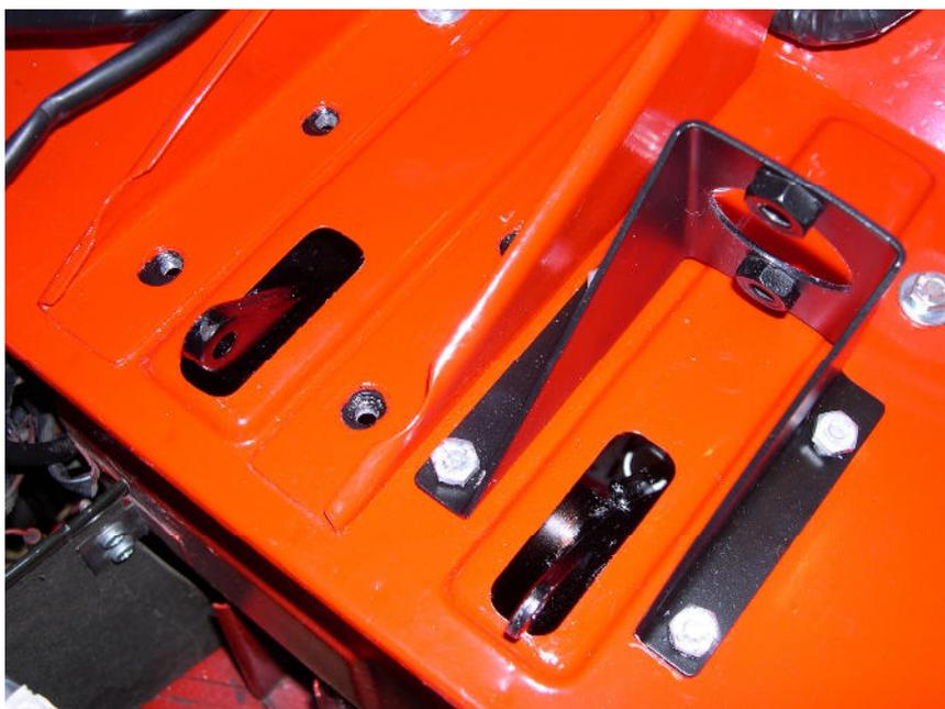
*Un particolare del pianalino durante il montaggio delle staffe delle pompe freno (a sinistra) e frizione (a destra).*
